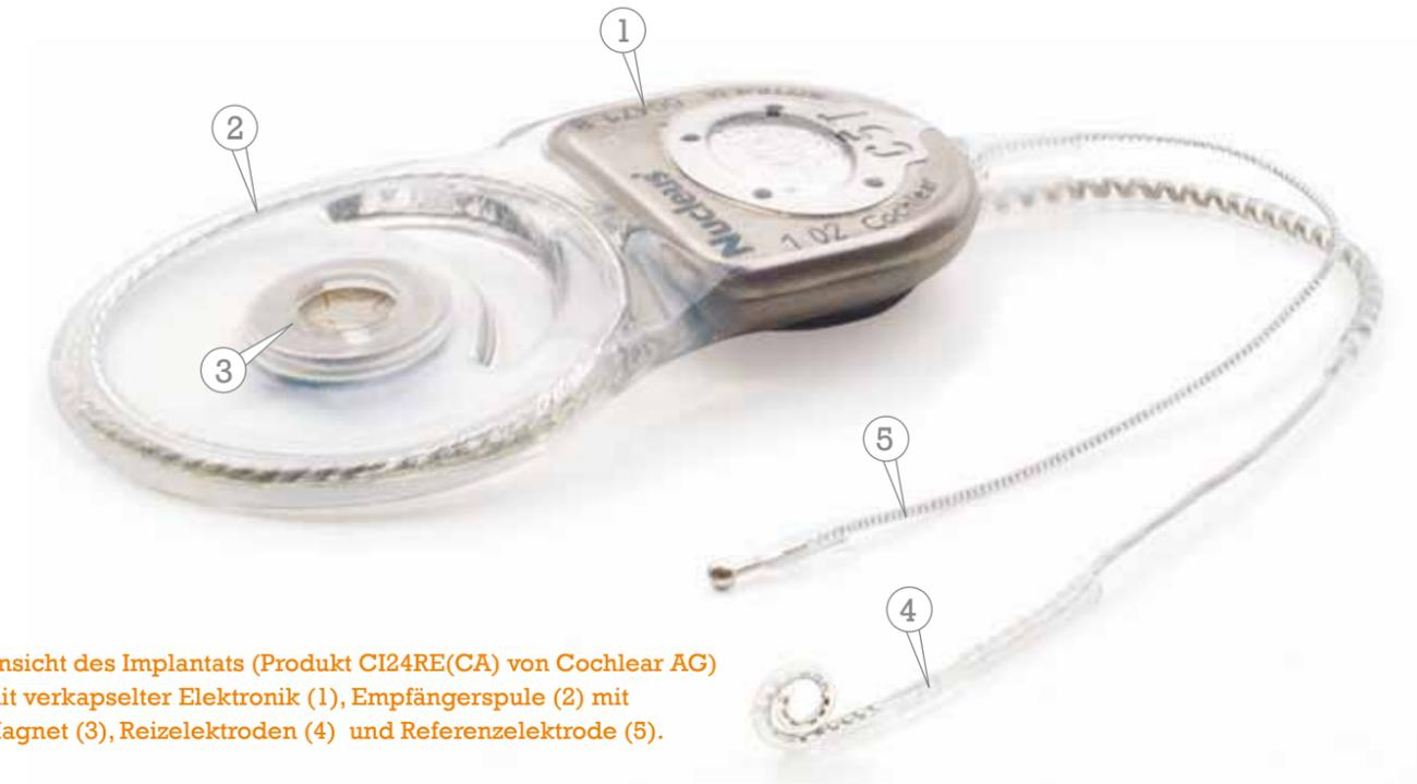
**Ansicht des Implantats (Produkt CI24RE(CA) von Cochlear AG) mit verkapselter Elektronik (1), Empfängerspule (2) mit Magnet (3), Reizelektroden (4) und Referenzelektrode (5).**
